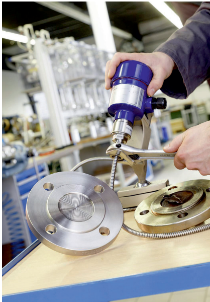
Bild 3. Reparaturservice für Druckmittlersysteme
